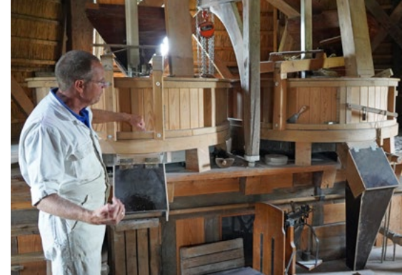
De molenstenen malen in een zelf gefabriceerde houten omkasting.
